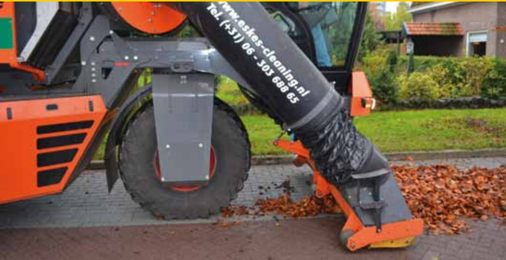
De exhausters zorgen voor een lichtsnelheid van 200 km/h in de pijpen
