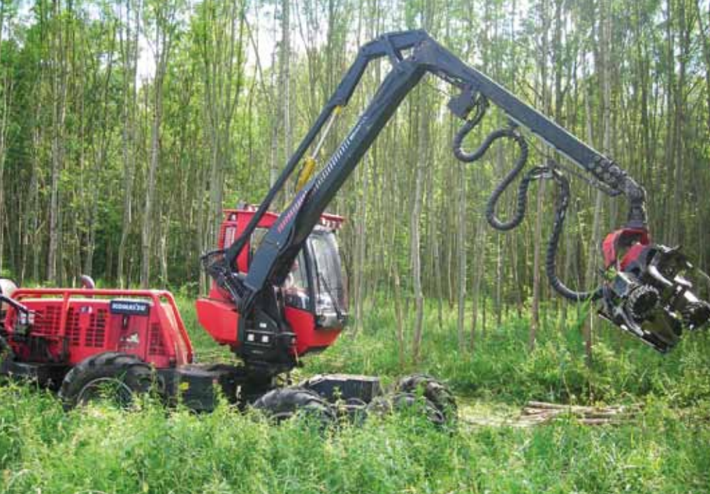
De machines van Van den Nagel grijpen bomen vast, zagen ze af, kantelen ze en zagen ze meteen op maat.
